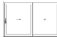
2-teiliges Element mit Hebe-Schiebeflügel und Festverglasung
